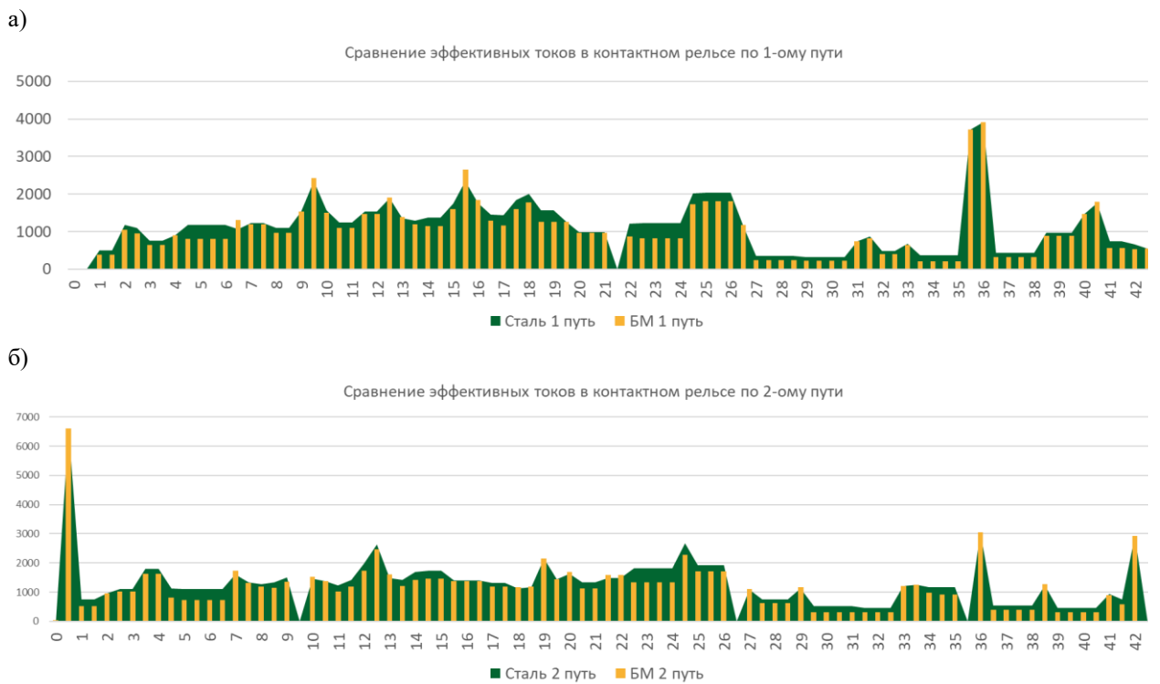
Рисунок 3 – Сравнение эффективных токов в контактном рельсе а) по 1-ому пути и б) по 2-ому пути
