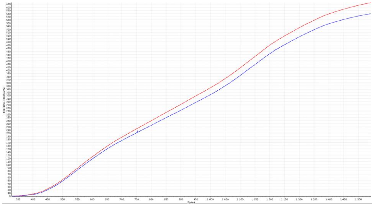
Рисунок 2 – Графики изменения расхода электроэнергии по всей линии для стального (красный график) и биметаллического (синий график) контактного рельса
